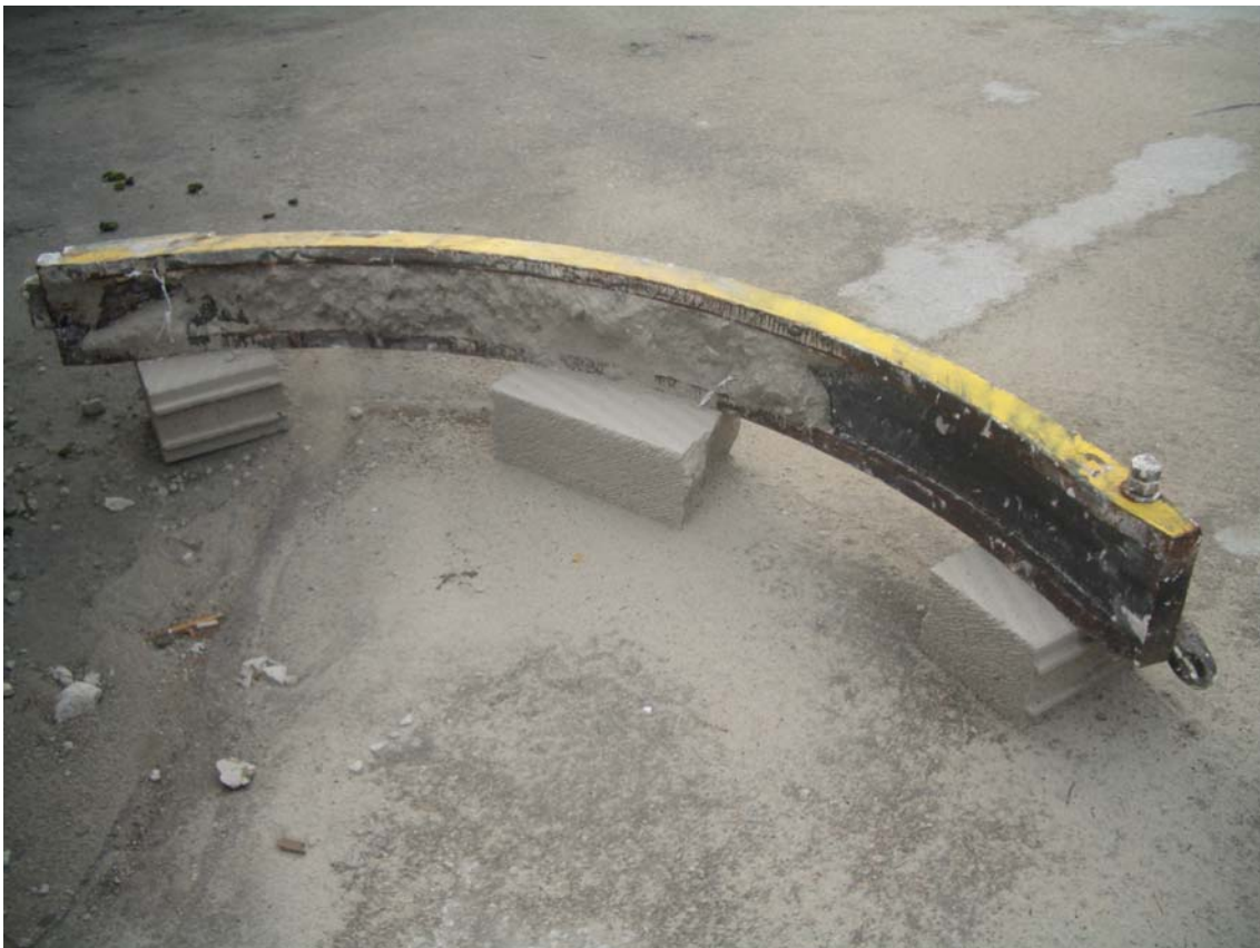
Fig. 5 – una delle due fasce di chiusura che hanno ceduto con i residui di materiale trafilato per effetto del fenomeno di steam explosion
