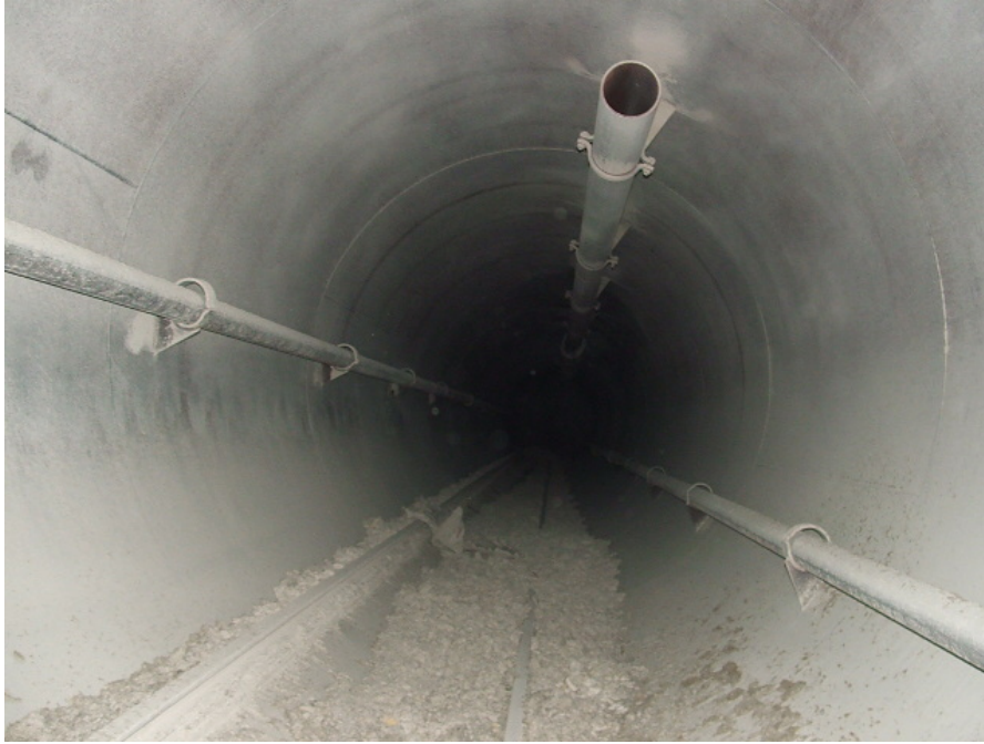
Fig. n. 4 – interno dell'autoclave dopo lo scoppio con i pochi residui rimasti delle 62 tonnellate di materiale trattato
